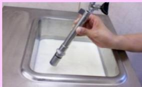
**5** ソフトミックスを排出する。最後に洗浄スイッチを押し残りを排出する。停止スイッチを押し「レバー」を戻す。
