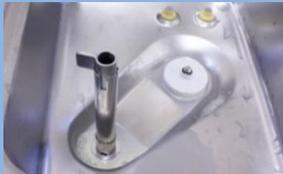
27 先程抜いた200mlと、新たにソフトミックスをいれて、ミックスランプの点灯を消し「タンクカバー」をする。
