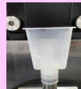
**10** 電源をOFFにし、ナットを外し、フリーガード部分を取り外す。
